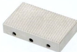
BP picadas (pirámides) Mandíbulas Picadas - Pirámides 1.2x45° - Acero endurecido 58 HRC - Niqueladas
