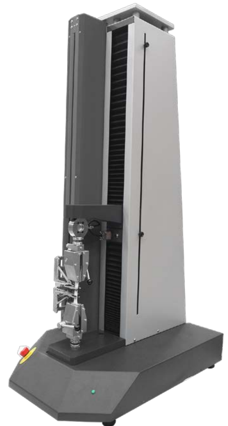
Maquina Universal de Ensayos MTE-5 equipada con Extensómetro de contacto de grandes alargamientos
