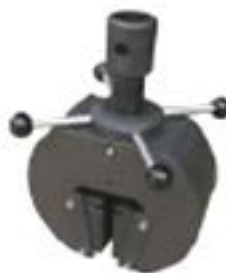
Mordazas tipo Cuña (Metales – Plásticos - Alambres – Cables - Composites...)
