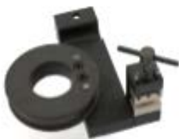
Mordazas 1 Rodillo (Hilos – Cuerdas – Alambres – Cables Finos Dúctiles...)
