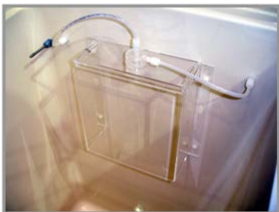
Nuevo Pulverizador fabricado en metacrilato, con mejores garantías de funcionamiento
